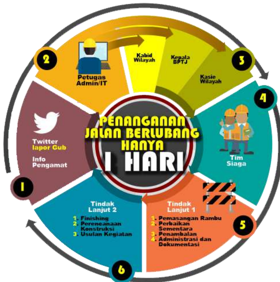
Gambar 5.4 Standard Operational Procedure (SOP) Penanganan Lubang oleh Balai Pengelola Jalan Dinas Pekerjaan Umum Bina Marga dan Cipta Karya Provinsi Jawa Tengah
